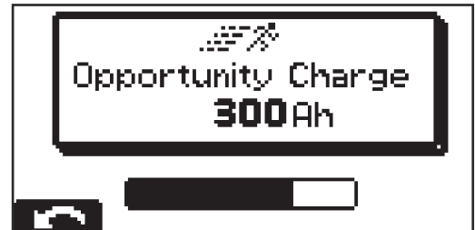
Indikering vid start av mellanladdning
