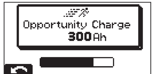
Anzeige bei Start der Zwischenladung
